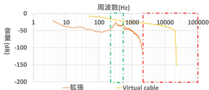
図 3 スweep音源を用いた電子聴診器の周波数特性 ( Virtual cable はパソコン内で処理するのでノイズなく音源そのものの周波数特性を示す )
