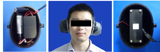
図 9 UV-LED 動作回路(左)、ヘッドセット型外耳道ガス計測装置装着時の写真(中央)、エタノールガス計測系(右)
