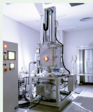
CMC製造の重要な課題である高速・低コスト化を図るために、熔融状態にあるSiをSiC繊維と炭素の予備成型体(プリフォーム体)中含浸し、SiC繊維の特性を劣化させることなく高性能なSiC/SiCを作製する技術を開発しています。製造条件を最適化するための理論解析やシミュレーションにも取り組んでいます。
