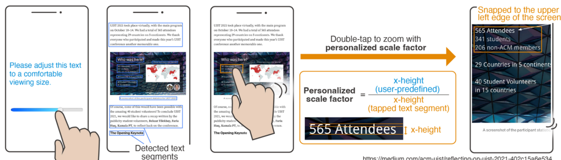
図 1 ターゲット認識型ズームの概要。ユーザは事前に自身が読みやすいと感じるフォントサイズを設定します。画面上のテキストコンテンツをダブルタップすると、事前に設定されたサイズと同じになるように、テキストが拡大されます。
