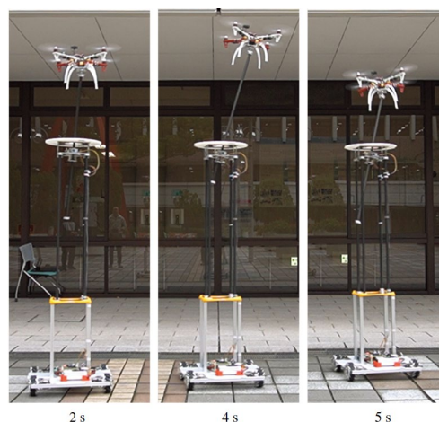
図 2 試作機による飛行追従実験の様子。クワッドローターと全方向移動オムニホイールロボットで構成した。
