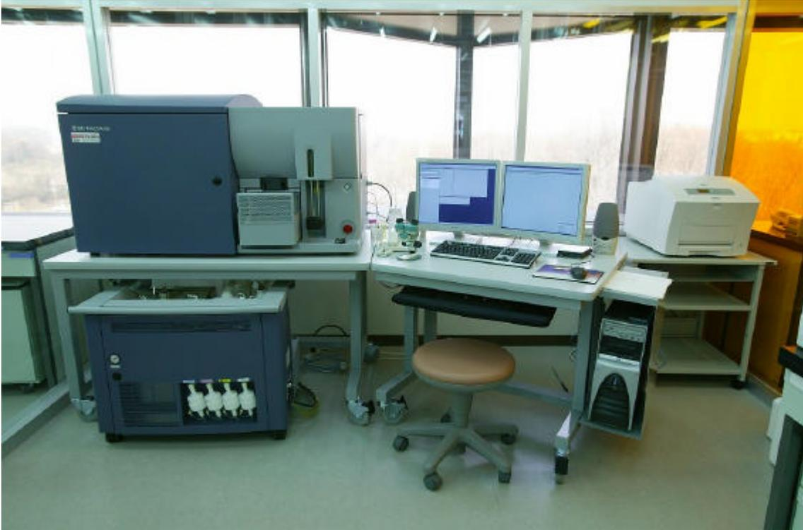
高感度かつ迅速に目的の細胞を分離するために用いられる装置です。遺伝子の探索やそのメカニズムの解明を行います。
