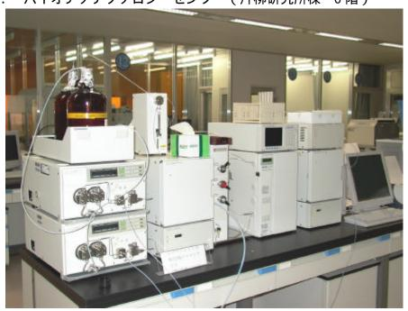
LC-8A 送液システム、SIL-10AF オートサンプラー、SCL-10A システムコントローラー、CTO-10AC カラムオーブン、SPD-M10A フォトダイオードアレイ紫外可視検出器、FRC-10A フラクションコレクタ、サンプルクーラー等の組み合わせからなる液体クロマトグラフシステムです。
