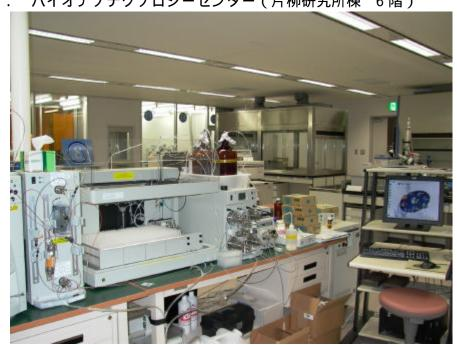
目的化合物の分子量を、あるいは特徴的な UV 波長をトリガーとする自動分取精製システムです。膨大な化合物ライブラリーの精製でフラクション数を大幅に減らし、目的成分のトラッキングとハンドリングを容易にします。
