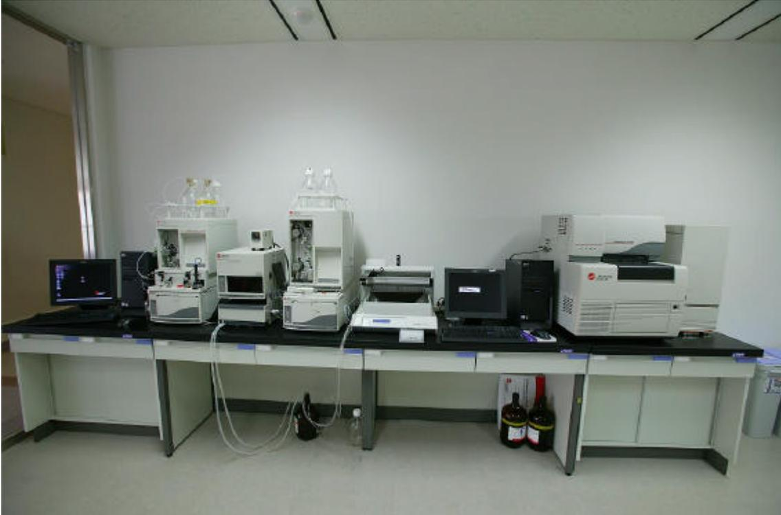
タンパク質の分離に使われる装置です。最初に特定の溶液を流し目的とするタンパク質をおおまかに分離した後、さらに厳しい条件で分離し（2段階で分離）目的のタンパク質を選択できます。タンパク質機能解析や有用タンパク質の取得に用いられ、疾病に関する標的分子の回収や疾病診断システムのセンサー開発などに利用できます。
