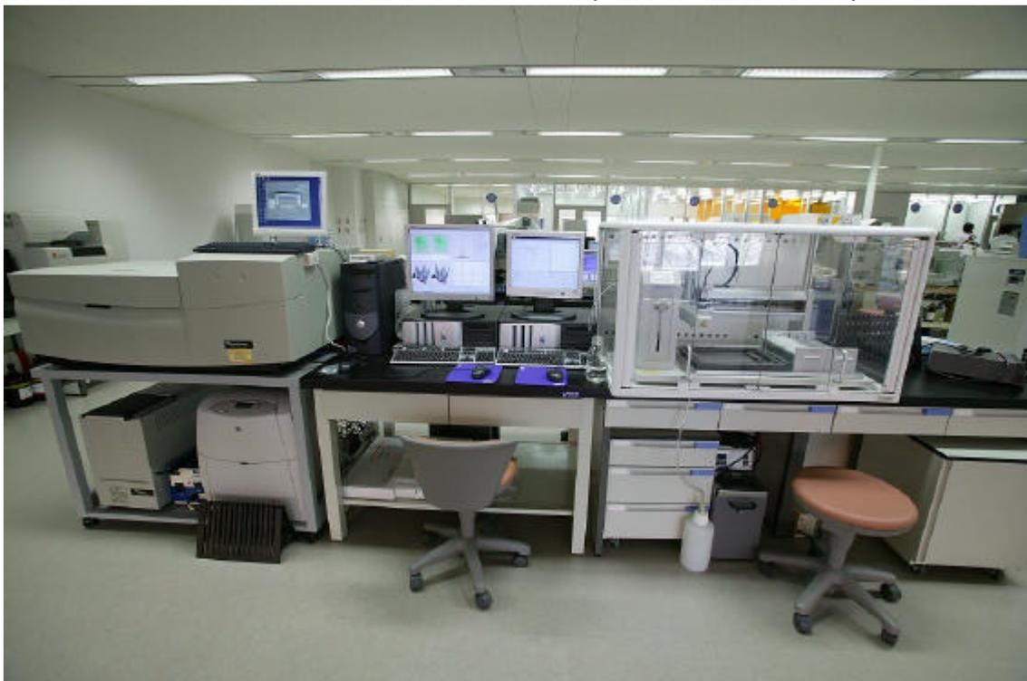
タンパク質の分離と目的のタンパク質をピックアップする装置です。特定のタンパク質を二次元電気泳動という方法で分離し、分離されたもののうち必要なものを選択しその分子量（大きさ）などを測定／回収する装置です。タンパク質の機能解析や有用タンパク質のスクリーニング、具体的にはガンなどの疾病メカニズムの解析や診断システムの開発や、色々なセンサー構築の際にターゲットとなる分子の検索を行うために利用されます。
