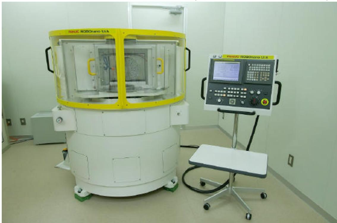
様々な材料をナノメートルオーダーで三次元的に加工することができます。タンパク質分離デバイス、タンパク質相互作用検知デバイスやタンパク質検出部分の検知窓の加工や様々なデザインされた極めて微細な溝の作製、各種チップの開発など、その利用は広範囲の分野におよびます。
