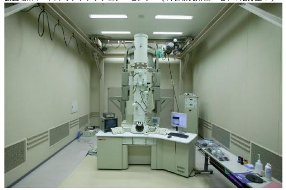
薄い試料を透過した電子を蛍光面に衝突させて、試料の拡大像を観察する装置です。ナノ薄膜の観察、ナノメートルでの分子や結晶の観察ならびに、細胞や生体物質の観察が可能です。 バイオテクノロジー、半導体、化学など様々な分野で最先端の研究開発に活用できます。
