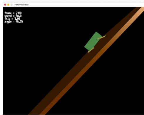
図 2-6 点拘束条件を用いた接着機構シミュレーションの様子
