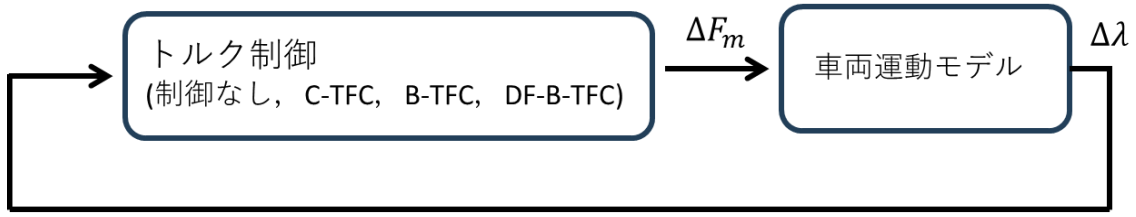
図 4-1 トルク制御のシステム全体ブロック図
