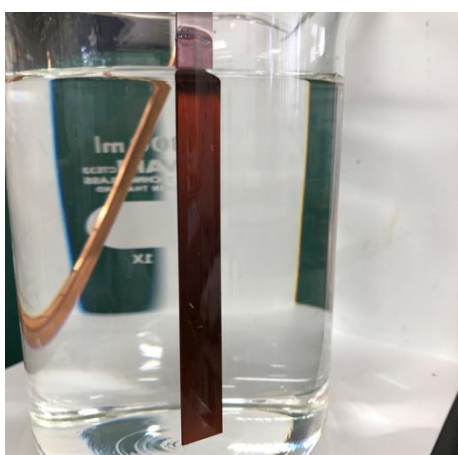
Fig 2-21. 絶縁性試験中の電着膜の様子 (気泡、発色ともになし)
