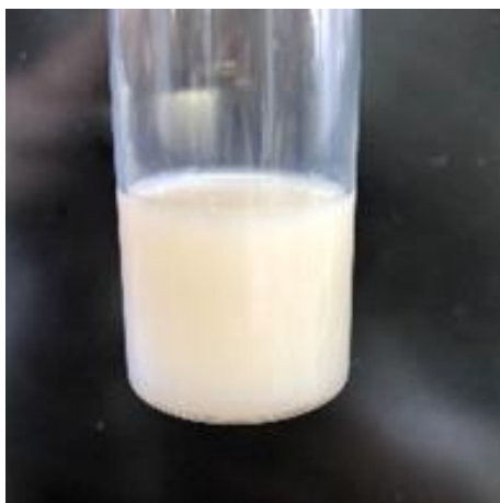
Fig 2-14. ポリイミド PI(BPADA/AHPP)-MA, NMP, ベーマイトアルミナゾル, メタノールで調製した微粒子分散液
