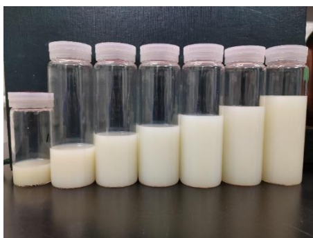
Fig 4-28. PAE(PMDA/ODA)の微粒子化における貧溶媒添加量の依存性 PAE 固形分濃度:左から順に 0.40,0.33,0.29,0.25,0.20,0.17,0.14,0.13,0.11 wt%、 PAE に対する AlOOH の濃度:15 wt% 左から順にエタノールの滴下量が 15、20、25、30、40、50、60、70、80 mL
