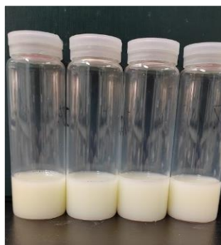
Fig 4-26. PAE(PMDA/ODA)/AIOOH の微粒子化における貧溶媒添加速度の依存性 PAE 固形分濃度:0.33 wt%、両溶媒と貧溶媒の組成比:1/2、PAE に対する AIOOH の濃度:15 wt%(左から順にエタノールの滴下速度が 15、10、15、20 mL/min)
