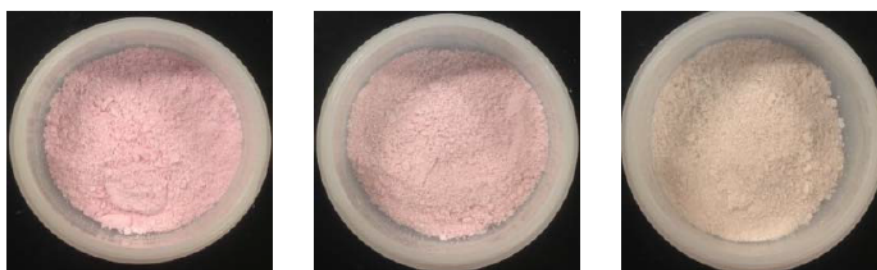
図 70 PE 色素/プロパノール処理多孔質シリカ複合体の外観
